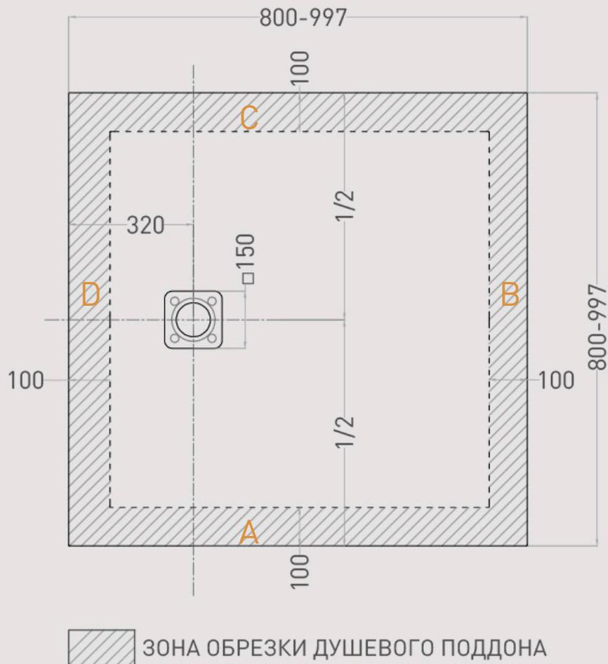
1. Возможность обрезки поддона до 100 мм с каждой из сторон (A, B, C, D).
